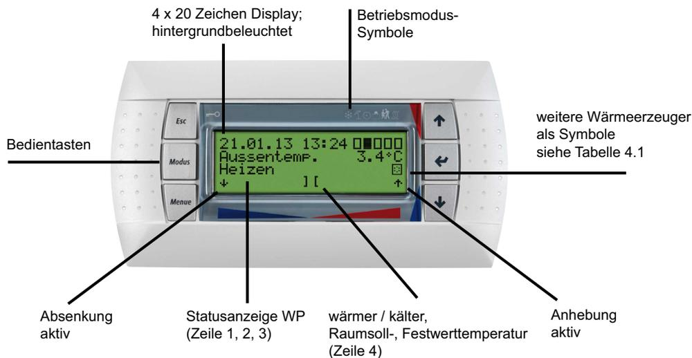
Abb. 4.1: Wärmepumpenmanager mit abgesetztem LC-Display Standardanzeige mit Bedientasten
